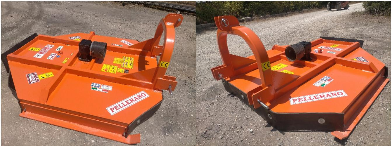
La struttura realizzata tutta in Hardox 450 permette senza alcun problema di affrontare qualsiasi tipo di condizione di lavoro.
